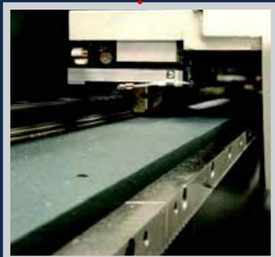
Guide lineari longitudinali su travi rinforzate Longitudinal linear guide rails on structural beams
