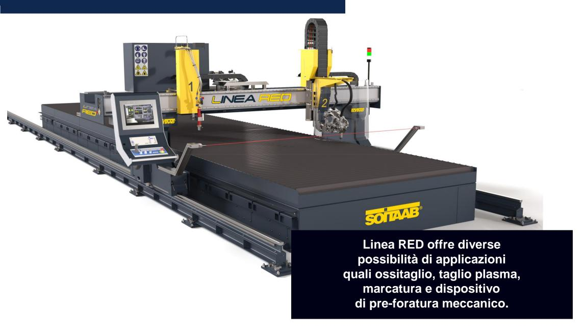
Dotata di struttura con doppia trave, doppia motorizzazione longitudinale con motori Brushless ed azionamenti digitali a coordinate assoluti, affida la movimentazione ad accoppia-menti pignone e cremagliera e un dispositivo di recupero giochi con molla di pre-carico.
