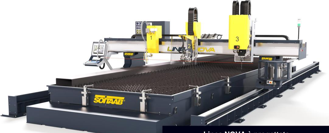
Linea NOVA è progettata con un concetto di modularità che la rende la macchina versatile e completa per eccellenza. Offre una vasta gamma di soluzioni per il taglio plasma, ossitaglio, foratura/maschiatura e marcatura.
