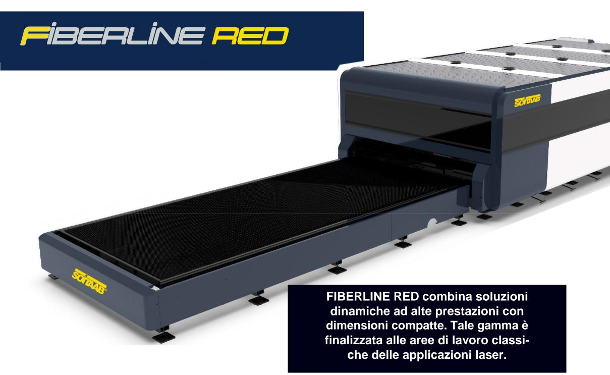
La macchina è accessibile frontalmente per le classiche opera zioni di manutenzione ed è visualizzabile internamente tramite la with compact dimensions. This range is aimed to the class finestra frontale protetta da vetro certificato.
