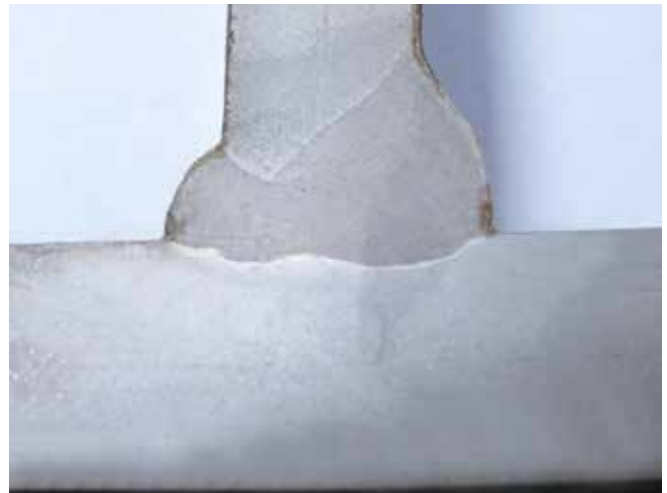
T-Stoß 8 auf 10mm T-joint 8 on 10 mm
